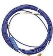
MX8031延长电缆可选择带或不带保护铠甲，并配备VibeLock™连接器和三轴电缆。它们与所有Metrix MX8030系列的5mm和8mm探头系统，以及BN 3300/3300XL的5mm和8mm探头系统兼容。
