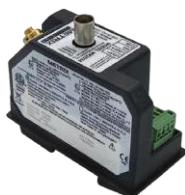
**MX2034 4-20毫安变送器：**4-20毫安电流输出 ( $\text{mA}/\mu\text{m}$  或  $\text{mA}/\text{mil}$ ) MX2034信号输出直接向PLC、DCSs、SCADA系统或其他接受ISA标准4-20 mA信号的仪器提供轴向位移、径向振动或轴转速测量，无需使用单独的监控系统。4线模型还包括可以发送到监控系统的原始信号。变送器由+24 Vdc供电，由电流环路提供。当连接到信号分析仪、便携式数据采集器和测试仪器时，短路保护的BNC连接器提供了对原始振动信号的方便访问。
