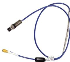
**MX8030**探头系列由5毫米和8毫米顶端直径探头组成，带有VibeLock™\*连接器和三轴电缆。8mm探头采用陶瓷顶端，适用于恶劣环境。这些型号提供符合API 670标准所需的所有标准螺纹尺寸和机身配置。两种探头均提供完整的 80mil (2毫米) 范围，并且在与匹配的MX8031延长线缆和MX2033前置器一起使用时提供完全符合API 670 的性能特征。MX8030探头可与BN 3300和3300XL 5毫米/8毫米探头完全互换。MX8030还可以在扩展范围模式下使用，以此检测完整的160密尔 (4毫米) 范围。
