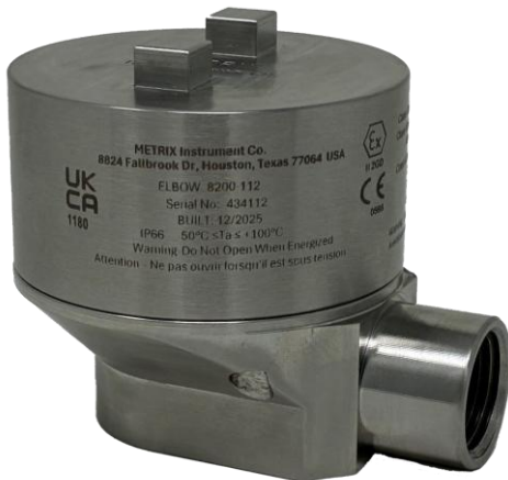
图1: 8200 不锈钢连接管肘1" NPT 雌性入口, 1/2" NPT 雌性出口
