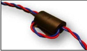
图 4：引线可穿绕磁环（Metrix 零件号：100463），以衰减不同频率的干扰信号。最佳缠绕圈数需根据现场工况及干扰频率灵活调整，缠绕好的磁环应安装在 8200 型管肘或同等规格管件内。
